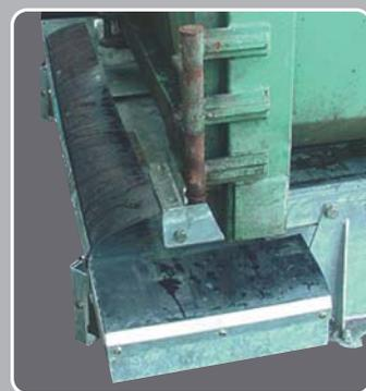
▲ Bac de rétention (600 L) avec indicateur de niveau et 2 ouvertures Ø 100 mm pour le pompage
